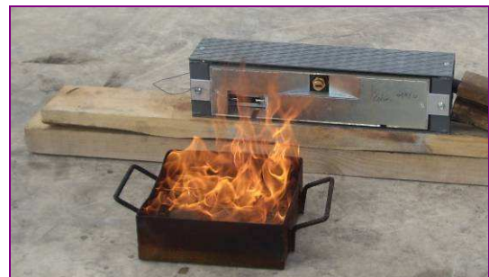
Foto: Ensayo de temperatura de activación de los detectores térmicos del equipo DEXA en el Laboratorio del fuego AFITI LICOF.
