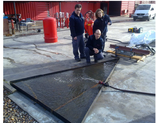
Foto: preparación ensayo de fuego del equipo DEXA con gasolina de 98 octanos en el laboratorio del fuego AFITI-LICOF (Laboratorio ENAC).
